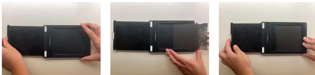
Figures 66, 67 i 68. Com es carrega una placa al portaplaques.
