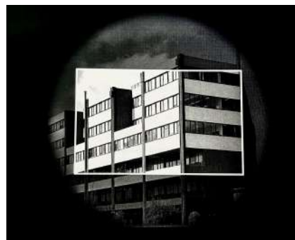
Figura 58. La mobilitat de la placa fotogràfica dins del cercle d'imatge dependrà de l'angle de la imatge i de la mida de la placa.
