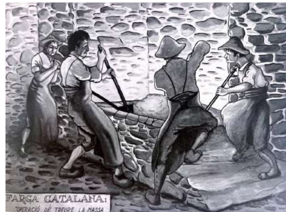
Figura 4: Aquarel·la que representa l'operació de treure el masser del forn. Dibuix de P. Serra. Font: La farga (p.55).
