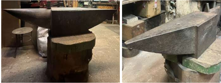
Figura 10: Enclusa sueca ubicada a l'obrador de P. Portella, comprada l'any 1994 (280 kg). Font: Pròpia.
