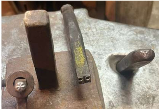
Figura 49: Estampes "P.P.", enclusa i estel que utilitza P.P. Bustins per marcar les diferents peces que fa. Font: Pròpia.
