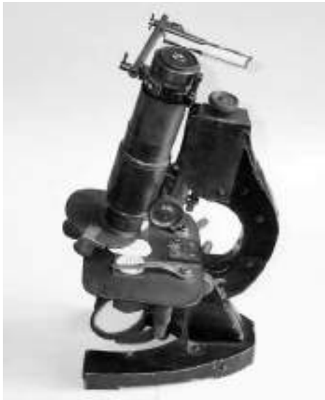
Figura 14. Microscopi Abbe construït per Margalef. Porta una càmera lúcida per facilitar el dibuix, en superposar en l'ocular la imatge del microscopi i el dibuix. (Arxiu Familiar Margalef-Mir)
