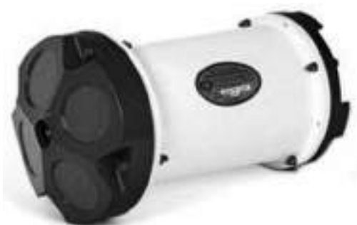
Figura 9. Correntòmetre Doppler per determinar els tres components de la velocitat.
