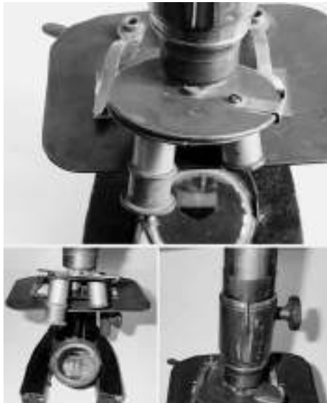
Figura 15. Detalls constructius del microscopi de Margalef. A part de les òptiques, les parts mecàniques de l'estatíu, la platina, el carro i el tub òptic, són fetes a mà. (Arxiu Familiar Margalef-Mir)
